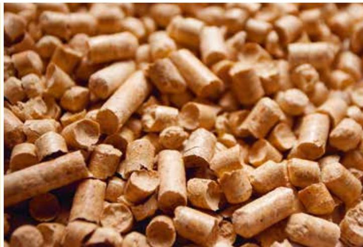
Kubikmetern dividiert man die Heizlast durch 2. So braucht man beispielsweise bei 90 kW Heizlast 45 m<sup>3</sup> beziehungsweise ca. 30 Tonnen Pellets pro Jahr. Bei einem Umstieg von anderen Energieträgern auf Pellets kann auch aus dem bisherigen Verbrauch der Pelletsbedarf ermittelt werden.
