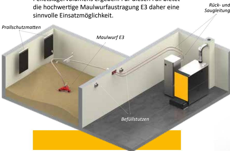
Mit der Maulwurfaustragung E3 lässt sich der Lagerraum fast vollständig entleeren und die schräge Holzkonstruktion entfällt.
