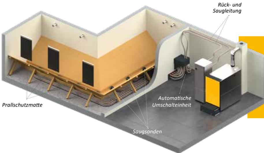
Mit den Saugsonden können nahezu alle Räume für ein Pelletslager genutzt werden, auch wenn sie verwinkelt sind. Bei größeren Lagerräumen sind auch 8 Sonden möglich.
