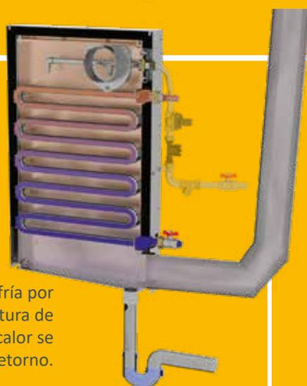
El humo se enfría por debajo de la temperatura de condensación. Con este calor se precalienta el agua del retorno.
