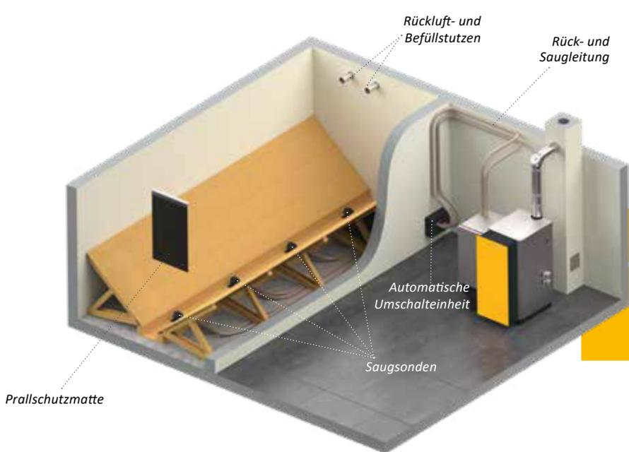
Mit den Saugsonden können nahezu alle Räume für ein Pelletslager genutzt werden, auch wenn sie verwinkelt sind.
