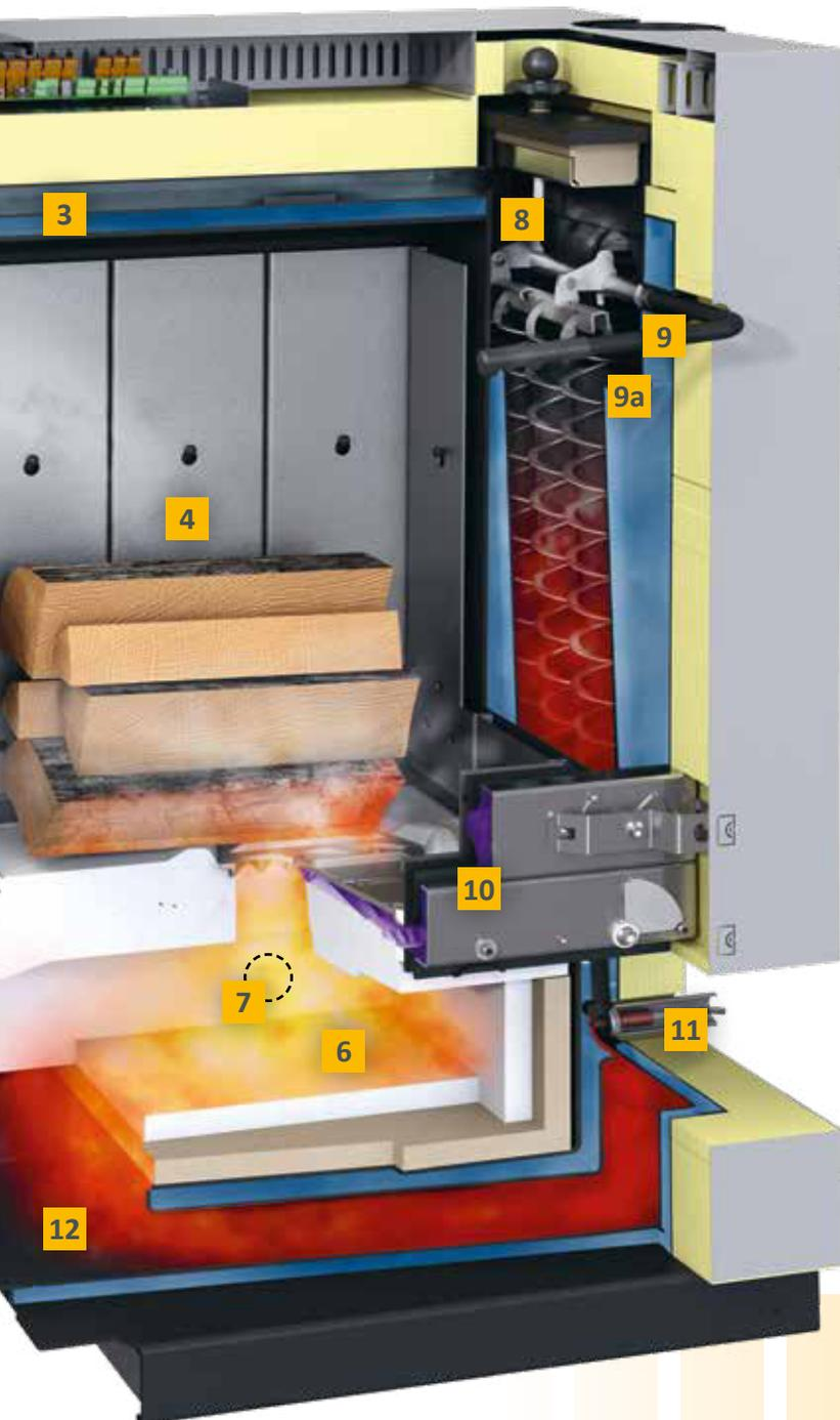
**8 Saugzuggebläse:** Flüsterleise sorgt dieser Ventilator für Unterdruck im Kessel. Zusätzlich regelt er dort die Luftmenge und sorgt damit für Sicherheit im Heizraum.
