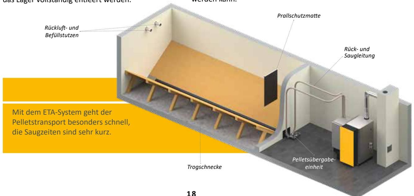
Mit dem ETA-System geht der Pelletstransport besonders schnell, die Saugzeiten sind sehr kurz.
