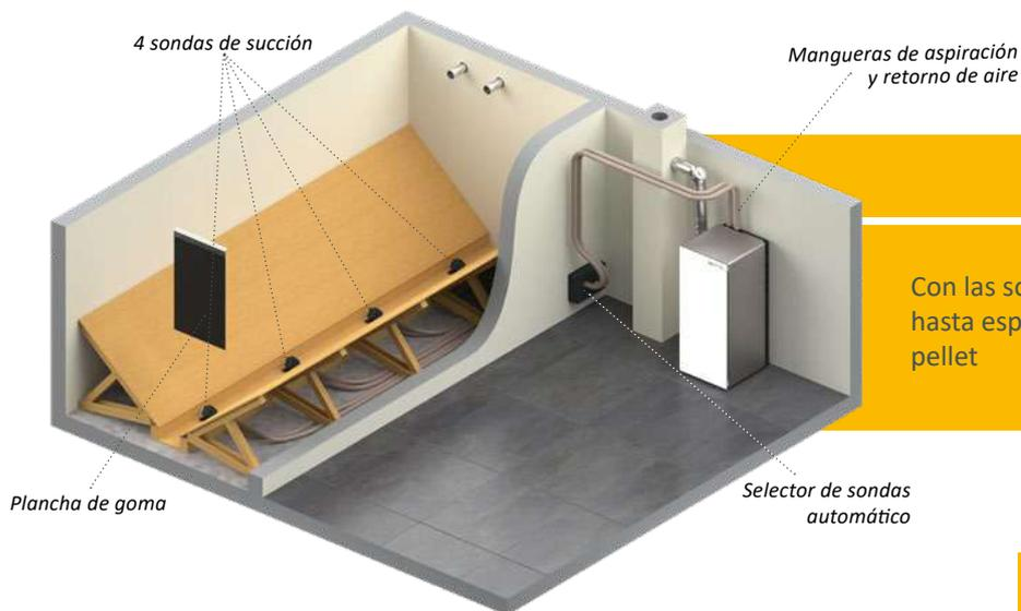
Con las sondas de succión se pueden utilizar hasta espacios en ángulo como depósito de pellet
