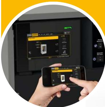
*Tanto la instalación solar, el agua caliente sanitaria o el acumulador buffer con módulo de agua caliente sanitaria: Todo el sistema se regula fácilmente desde la pantalla de la caldera.*
