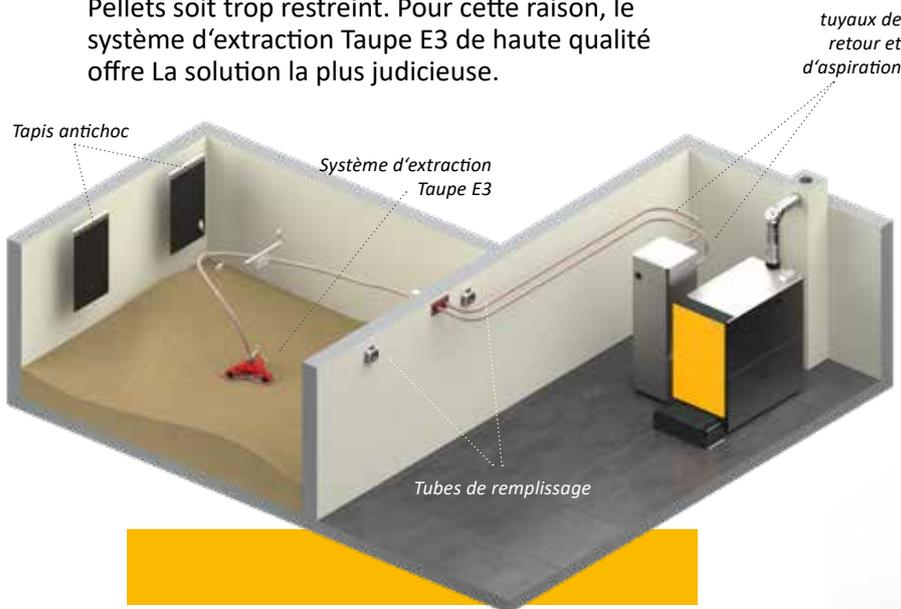
Le système d'extraction Taupe E3 permet de vider pratiquement entièrement le volume de stockage, et supprime les pentes de la construction en bois.
