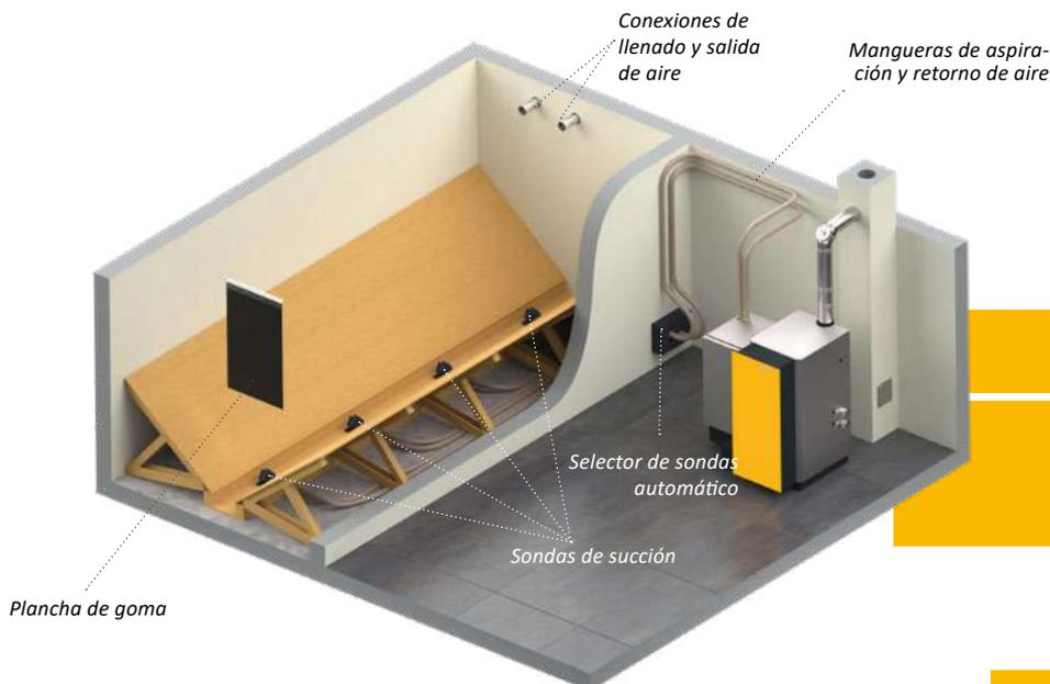
Con las sondas de succión se puede utilizar cualquier local como depósito, aunque no sea recto.
