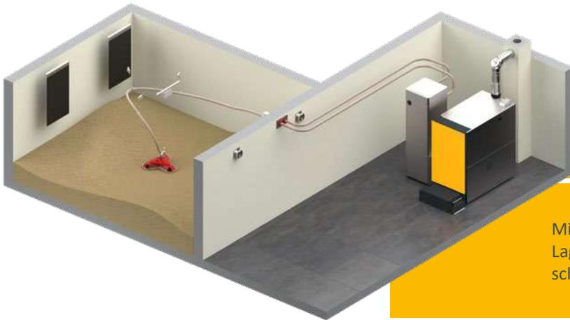
Mit der Maulwurfaustragung E3 lässt sich der Lagerraum fast vollständig entleeren und die schräge Holzkonstruktion entfällt.
