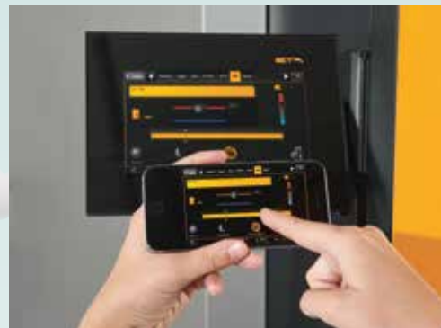
S pametnim telefonom, računalnikom ali tablico lahko kotel upravljate enako, kot če ste neposredno pri zaslonu na dotik.
