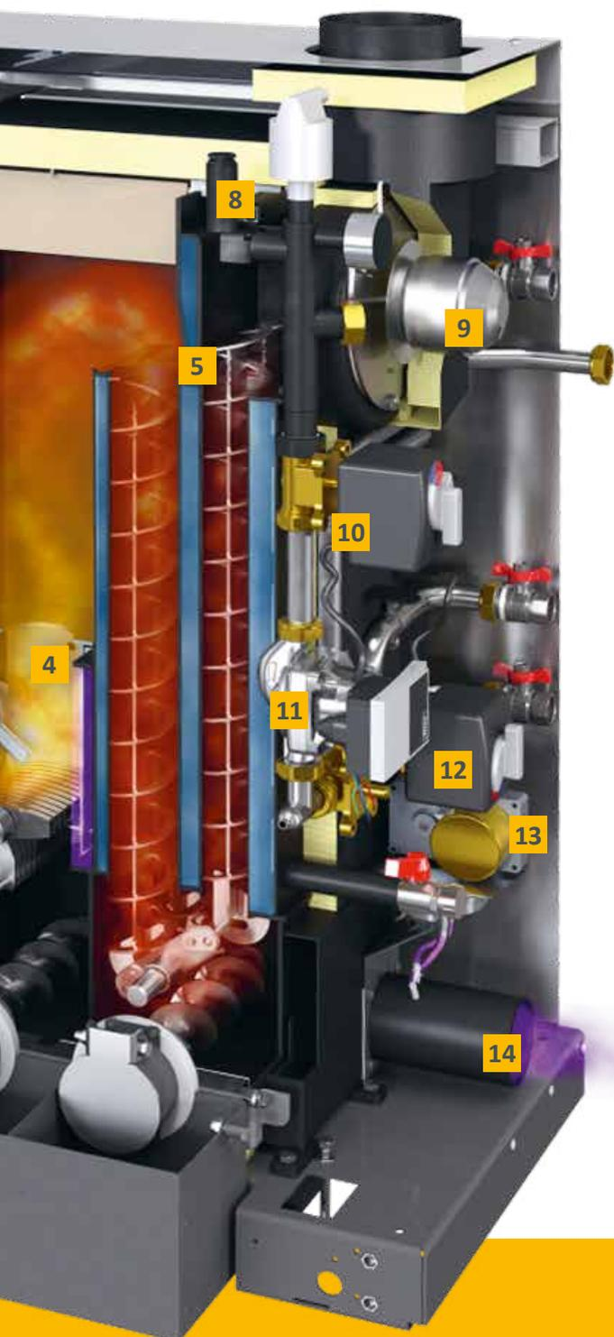
**8 Elementos de seguridad:** La caldera dispone de válvula de seguridad y sensor electrónico de presión para proteger contra presión excesiva. También tiene un purgador rápido integrado, para sacar el aire indeseado de los circuitos de calefacción. La caldera no necesita ninguna válvula de descarga térmica, ya que la cantidad de combustible dentro es tan pequeña que no hay riesgo de sobrecalentamiento.
