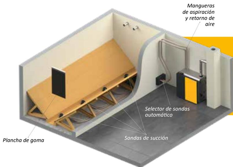
Con las sondas de succión se puede utilizar casi cualquier local como depósito, aunque no sea recto. En depósitos más grandes también se pueden instalar 8 sondas de succión.
