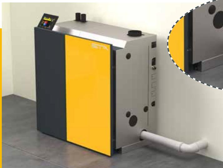
**Funcionamiento como caldera estanca** La ETA PelletsCompact se puede utilizar como caldera estanca, de forma que el aire para la combustión se suministra desde el exterior, y no desde el ambiente del local donde está instalada. Esto significa que la caldera también se puede instalar dentro de la zona calefactada del edificio, sin tener que tener una ventana todo el tiempo abierta en pleno invierno.
