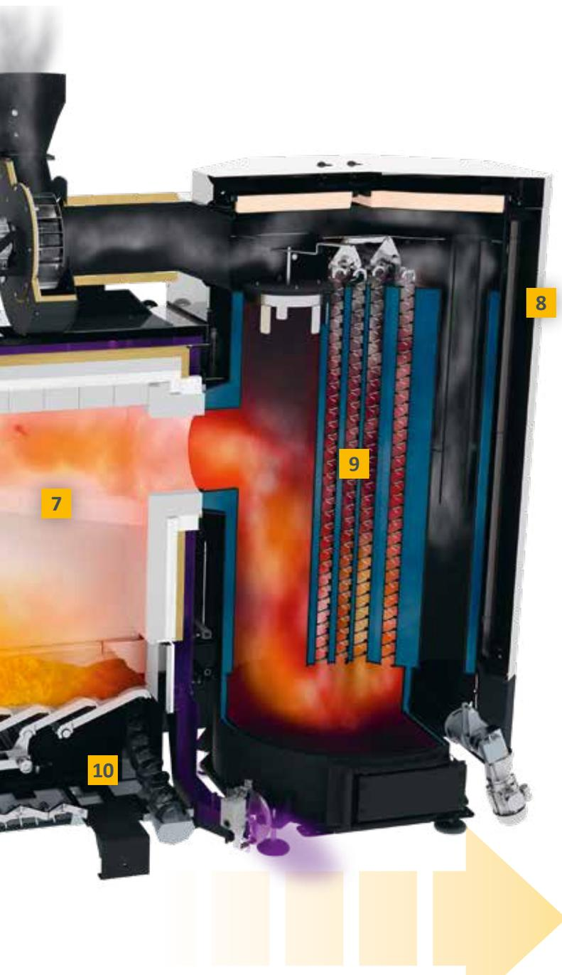
continu. Des longerons latéraux protègent de surcroît les côtés de la chambre de combustion. Ceci assure une longue durée de vie à la chaudière. Le décendrage s'effectue automatiquement tout en ne nécessitant qu'un entraînement commun pour la grille et le râtelier à cendres.
