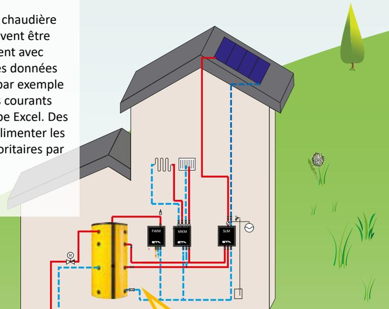
L'accumulateur à **stratification** ETA, l'échangeur ECS, le module de circuit mélangeur et le module de stratification travaillent ici parfaitement ensemble.
