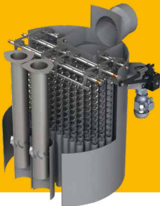
**Cyclone multiple anti-poussière et étincelles** Ce système est composé de deux tubes cyclones verticaux avec des guides de rotation en tôle soudée, intégrés dans l'échangeur de chaleur. L'encombrement requis est ainsi minimisé par rapport à un appareil externe tout en économisant les coûts supplémentaires. La rotation du cyclone multiple hache les particules grossières de poussière, prévient le danger d'étincelles et réduit les valeurs d'émissions de poussières.
