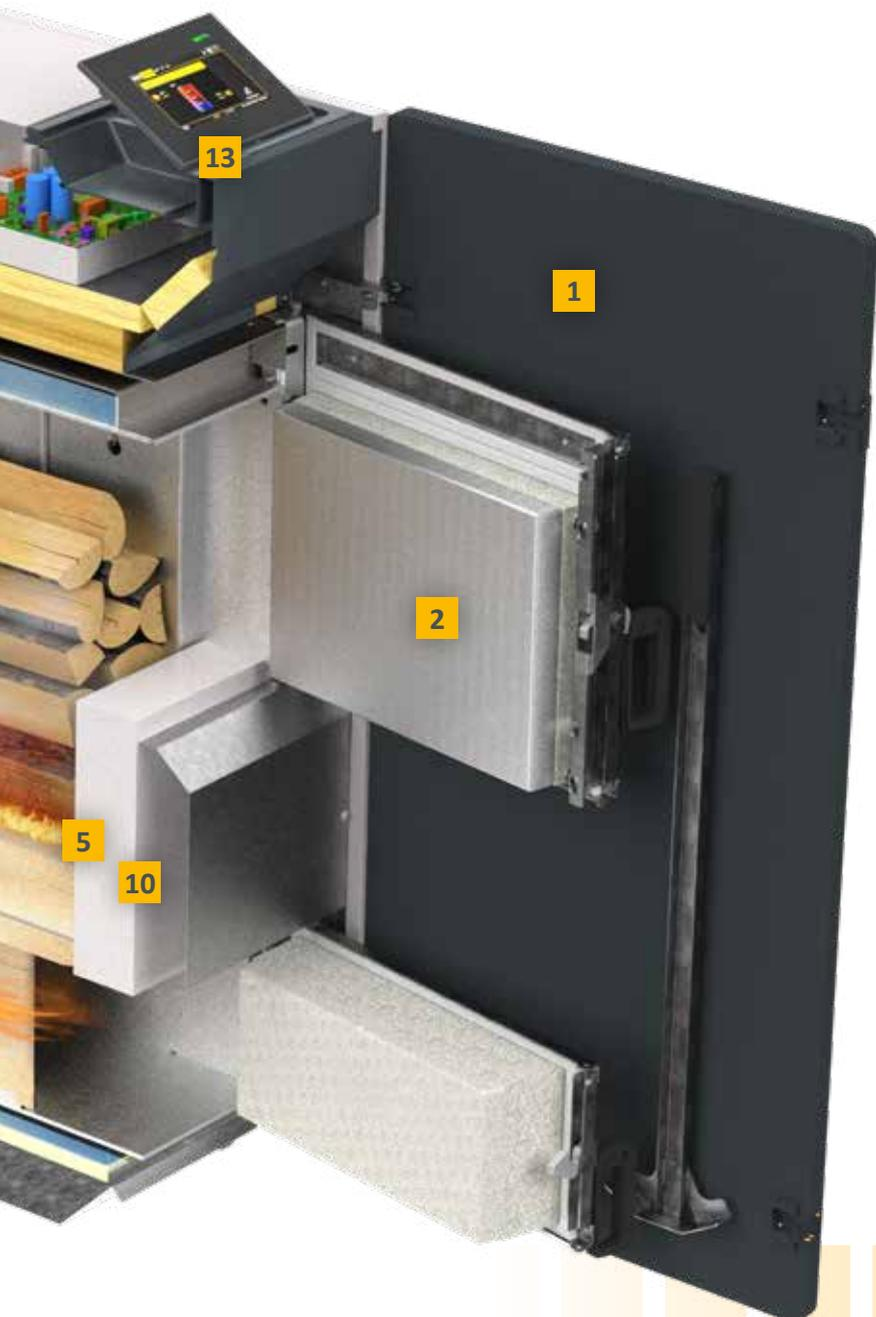
**10 Valvole dell'aria primaria e secondaria:** le due valvole sono comandate dalla sonda lambda in modo tale, che nella camera di combustione giunga sempre la quantità d'aria ideale per la combustione.
