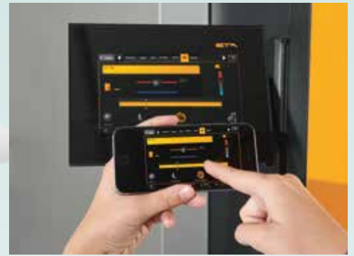
Via Smartphone, PC oder Tablet kann der Kessel und das Heizumfeld genauso bedient werden, wie auch direkt am Touchscreen
