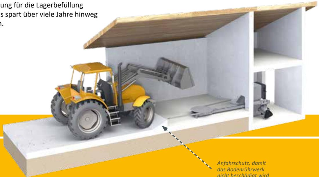
*Anfahrerschutz, damit das Bodenrührwerk nicht beschädigt wird*
