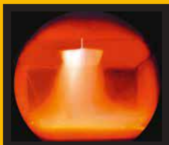
Värmebilden visar tydligt hur kraftigt luftgasblandningen virvlas i brännkammaren. Den här ständiga rörelsen bidrar på ett avgörande sätt till en förbränning med låg nivå av restprodukter.
